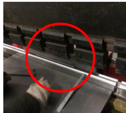
4.车间剪板机切入部位无防护（安装声光报警装置或格栅）
