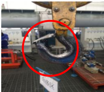
1.车间起重机械吊钩防护锁破损
