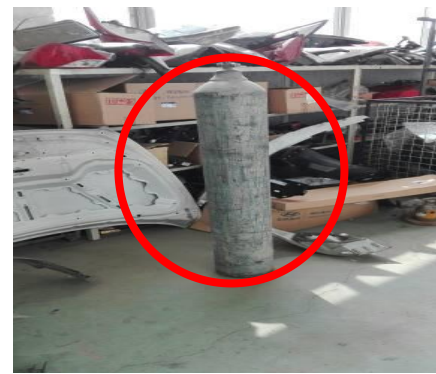
8.乙炔瓶随意放置，无防止倾倒措施
