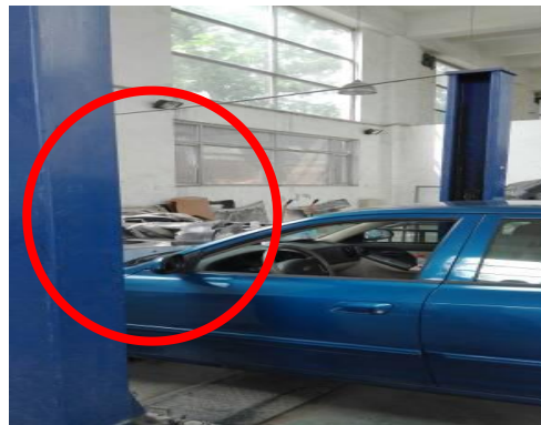
6.升机无安全警示标志
